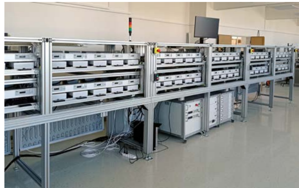
Автоматизированное устройство ELMA для тестирования счетчиков (нестандартное горизонтальное размещение счетчиков)
