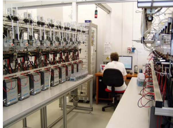
Устройство ELMA для тестирования электросчетчиков с фиксированной системой перемещения счетчиков (стандартное, вертикальное размещение счетчиков)
