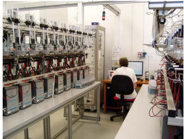
Obiekt testowy ELMA ze stacjonarnymi stojakami ze standardowym pionowym umieszczeniem liczników
