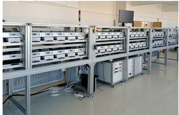
W pełni zautomatyzowane urządzenie testowe ELMA z niestandardowym poziomym umieszczeniem liczników
