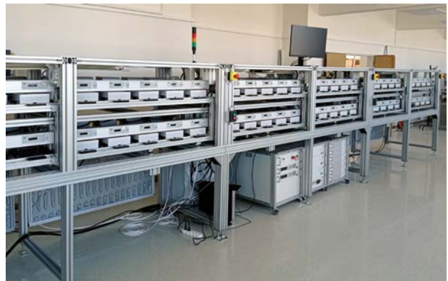
Equipo de contraste ELMA totalmente automatizado con colocación horizontal no estándar de contadores
