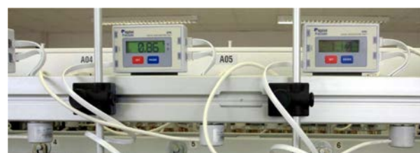
OPS 400 на стенде с системой EDEX
